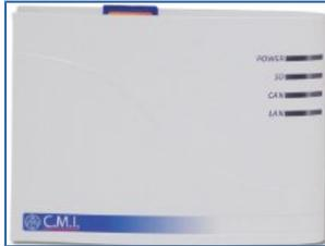
Das CMI (Control and Monitoring Interface) dient als Schnittstelle zwischen der Regelung und dem PC bzw. dem Internet (falls LAN-Anschluss vorhanden).
